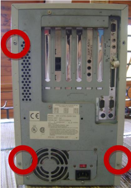
El gabinete de la computadora suele estar compuesto por dos partes: un armazón donde van acoplados las partes que la componen (Motherboard, disco duro, placas de audio/video, etc.), y una carcasa que lo recubre. La parte trasera del gabinete es por donde conectamos los periféricos de entrada y de salida, como el teclado, el mouse y el monitor, y donde se encuentra atornillado el armazón a la carcasa.
