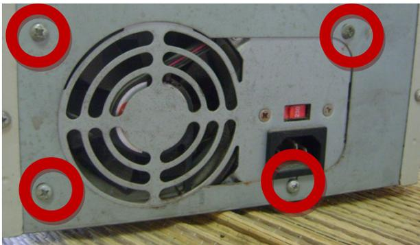
Algunos gabinetes presenta en su lado exterior más tornillos para sacar. Estos pueden pertenecer tanto a formas de agarre de la estructura interna del armazón, o de sus componentes: lo que agarra la fuente de alimentación al gabinete, o los tornillos para aferrar ciertos puertos de comunicación como los que se encuentran habitualmente en la salida del monitor. Con la ayuda del destornillador, extraemos dichos tornillos.
